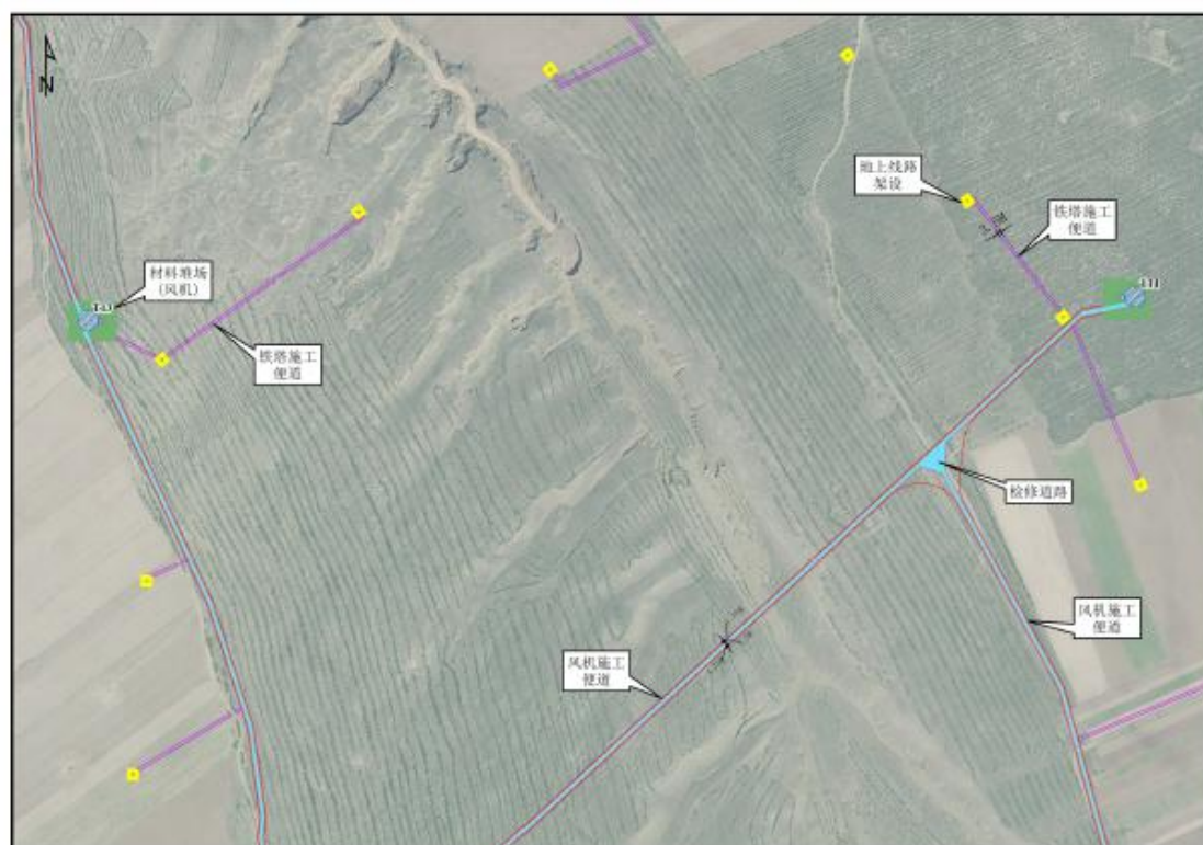
图 2-4 施工便道（局部）平面布局图
